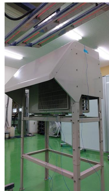
フード有での試験状況
