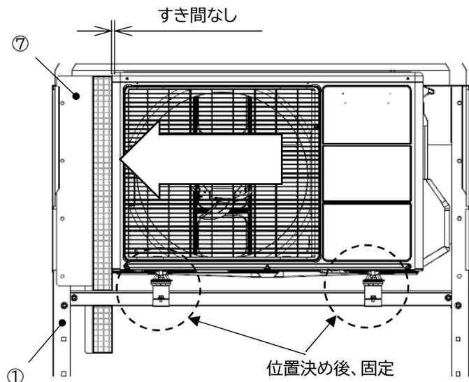
正面側の①架台支柱1に⑦ショートサーキット防止金具を⑨フランジボルトで取り付けます。次に、室外機と⑦のクッション材の間にすき間ができないように室外機を左側に寄せ、その後トメカナグで固定します。
