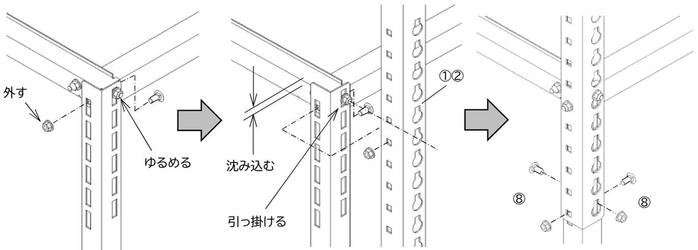
架台のキャクを止めている正面のボルト・ナットを外し、側面のナットを緩めます。
