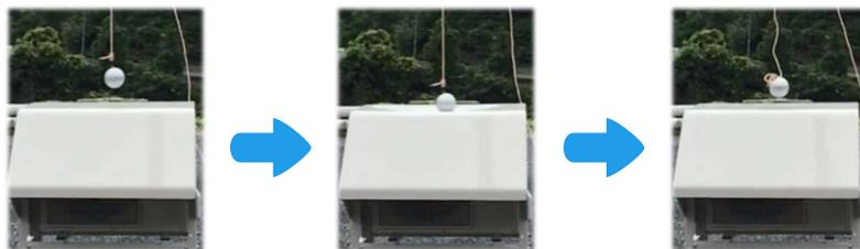
◎落下実験② 20kgの土嚢を4.5mの高さから落としても一瞬へこむだけ。
