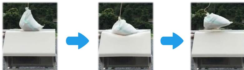
◎荷重実験 80kgの重しをのせても5mmたわむだけ。重しを外すと元に戻る。
