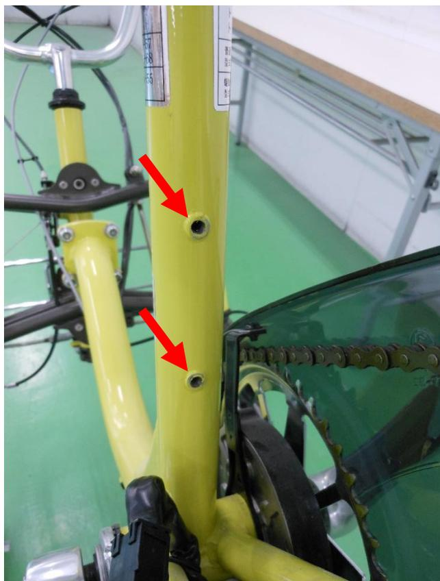
旧バッテリーハンガーを取り外すとフレームに開いたネジ穴が見えるようになります。
