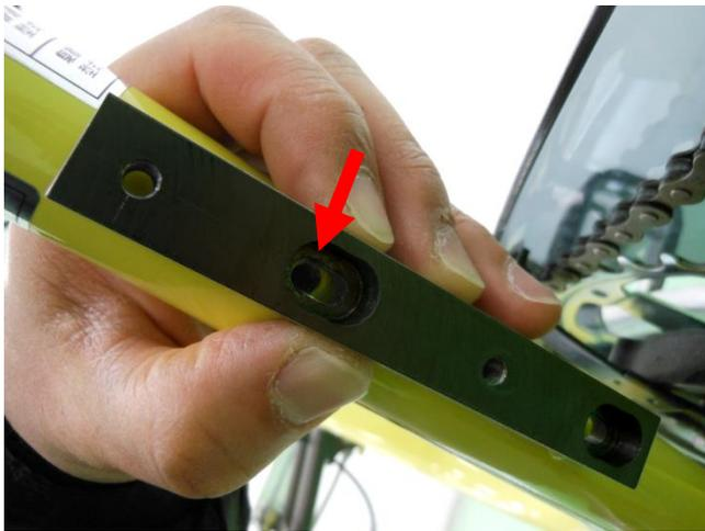
フレームのネジ穴の前にアタッチメントをあて、長穴からフレームのネジ穴が見える様、位置を調節します。
