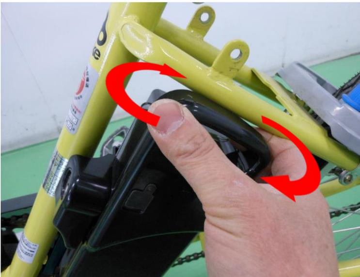
もし「カチッ」という音がならない、または手前に引くとバッテリーが外れるという場合は、バッテリーの取っ手部分を、上から見て時計回りにねじる様に力を加えてください。この時、バッテリーが手前に倒れない様、親指側に力を入れ、しっかり固定して行う様にします。
