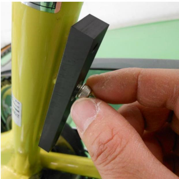
アタッチメントに付属のネジを、アタッチメントが上下に動く程度に、指で軽くねじ込みます。
