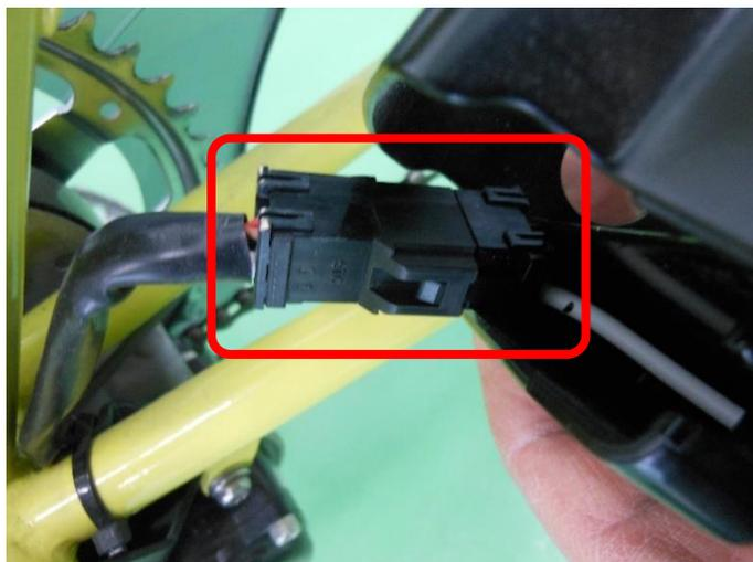
モーターとハンガーを結ぶ電気コードの、接続コネクタの色と形状で、キットに対応しているか判別できます。
